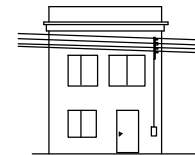
Instalación de acometida aérea con entrada aérea
