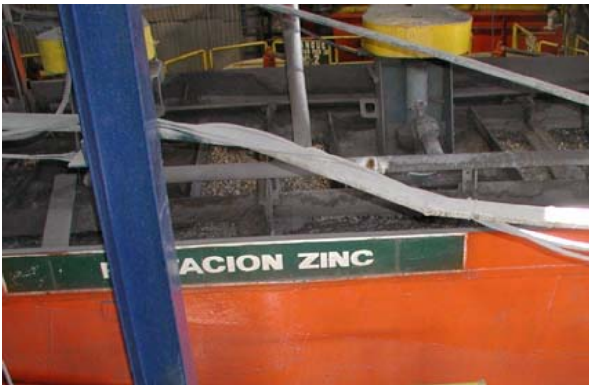
Fotografía 17: Sección Flotación zinc. Conformados por bancos de celdas, se obtiene concentrado con 48% Zn con una recuperación de 74 - 75% Zn.
