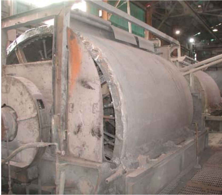
Fotografía N° 18: El filtrado de Zinc se realiza en cuatro filtros de vacío tipo Tambor de 11.5' x 12', el producto final sale con una humedad de 12.5 %.
